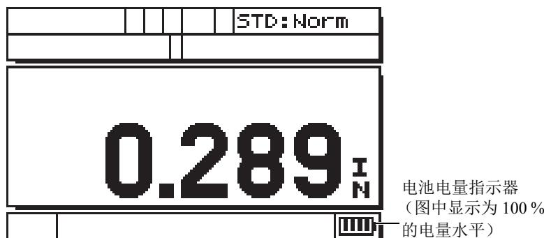
图 2-1 使用电池时的电量指示器
