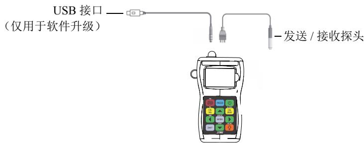
图 1-2 27MG 仪器的连接
